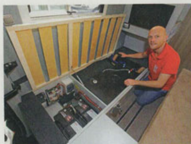
ZENTRAL Heizung, Frischwassertank und Bordelektronik gut zugänglich in der linken Sitzbank
