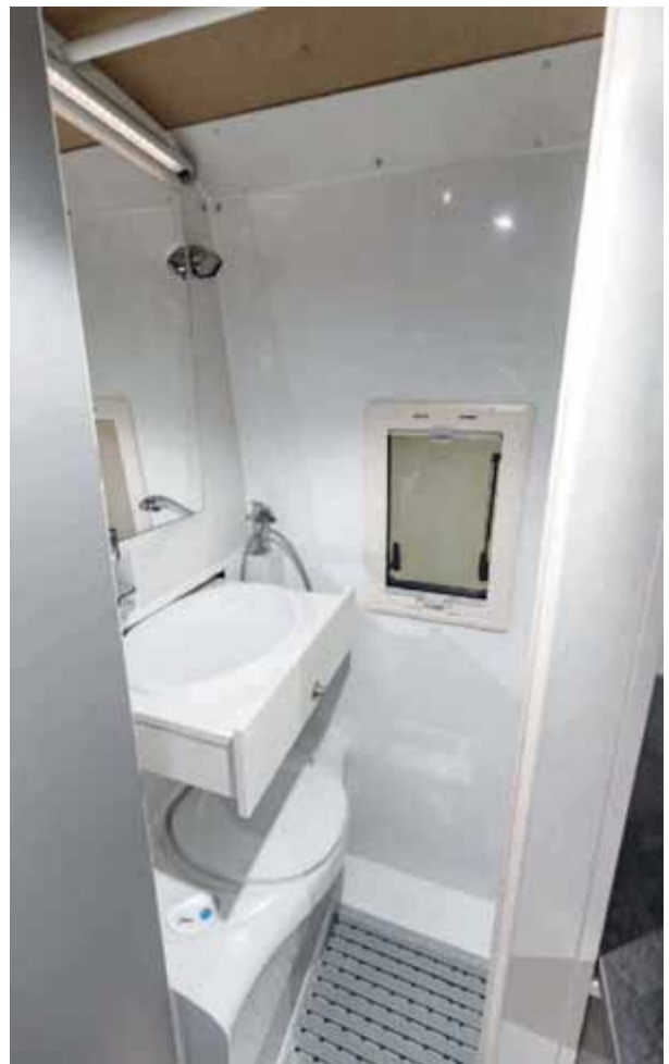
Sanitärraum mit ausziehbarem Waschbecken, Kassettentoilette, Spiegel und Duschgelegenheit im Vorhang
