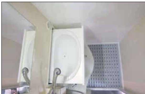
Sanitärraum mit ausziehbarem Waschbecken, Kassettentoylette, Spiegel und Duschgelegenheit mit Vorhang
