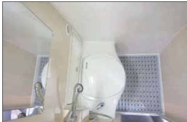
Sanitärraum mit ausziehbarem Waschbecken, Kassettentoylette, Spiegel und Duschgelegenheit mit Vorhang
